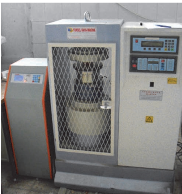
Slika 4. Ispitivanje uzoraka na tlak i na savijanje
