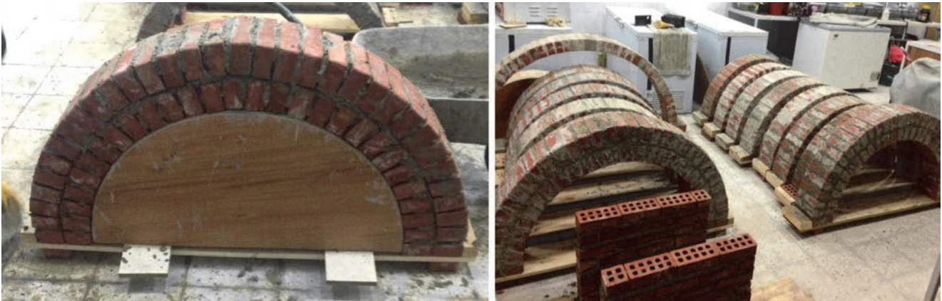
Slika 3. Prikaz izrade zidanih lukova na drvenim kalupima te proces sušenja
